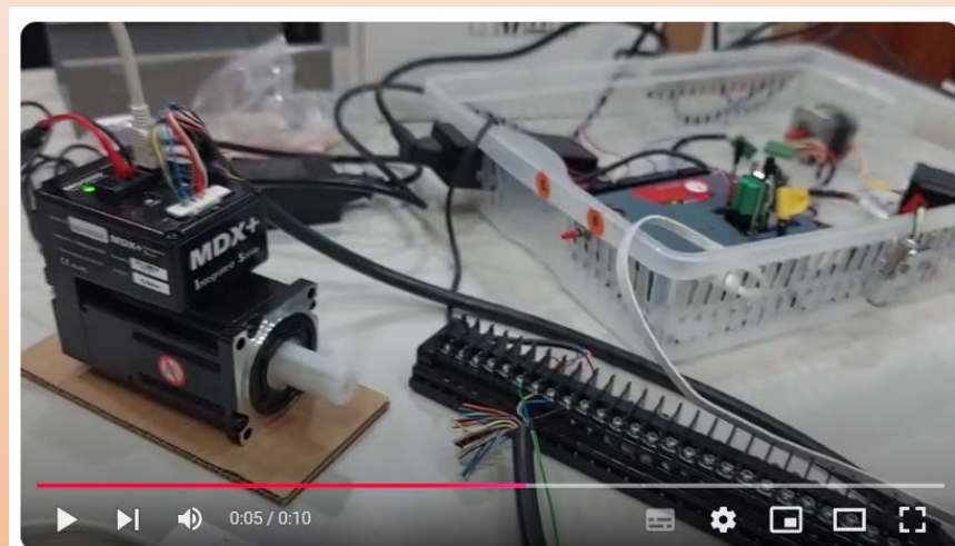
MDX+ 一體型伺服馬達/控制器 脈波模式控制 [with Trio 運動控制器]
