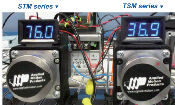
▲ TSM馬達和開迴路步進馬達，持續運轉30分鐘後，實際量測升溫情形
